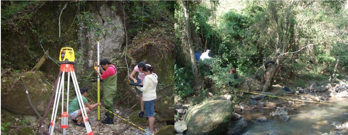
Figura 10. Trabajo en campo para el análisis de la ribera máxima y medición de la profundidad (izquierda), así como la determinación del área de inundación.
