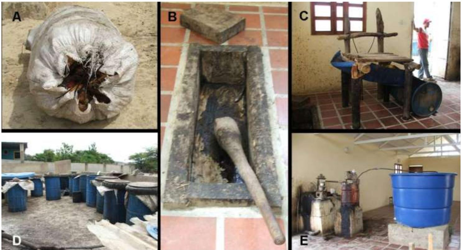
Figura 4. Fotografías que muestran parte del proceso de extracción del cocuy de penca a partir de *Agave cocui*. A) Cormo o tallo del *A. cocui* luego de su cocción, B) molienda, C) extracción, D) fermentación y E) destilación (Fotos: Carmen J. Figueredo)
